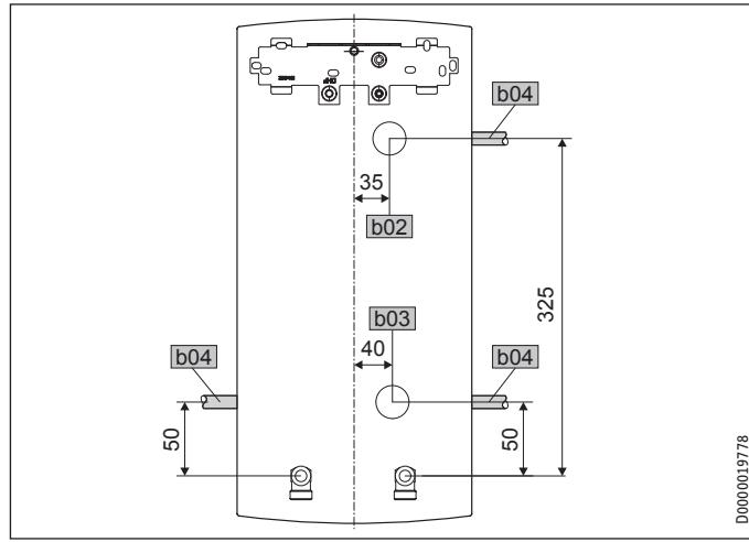
b02 Provodenje električnih vodova I
