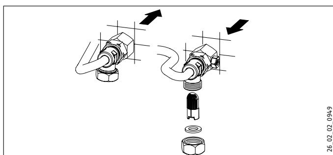
V případě znečištění očistěte sítní filter ve šroubení přípojky studené vody. Uzavřete uzavírací ventil v přívodu studené vody, než sítní filter vyjmete, očistěte a opět namontujete.
