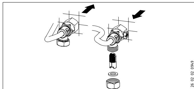
W razie zabrudzenia, oczyścić sitko w przyłączu zimnej wody. Podłączyć zawór odcinający przewodu doprowadzającego wody zimnej przez wymontowaniem, oczyszczeniem i ponownym zamontowaniem sitka.
