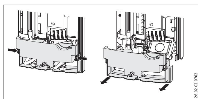
► Separe la pared posterior apretando los dos ganchos de enclavamiento y retirando la parte inferior de la pared posterior hacia adelante.
