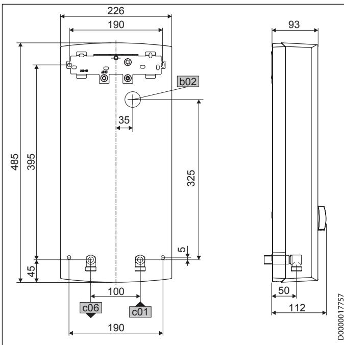
b02 спроведување на електричните водови I
