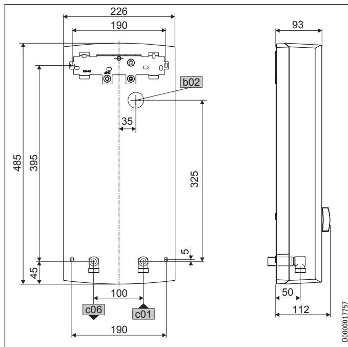
b02 Provodenje električnih vodova I
