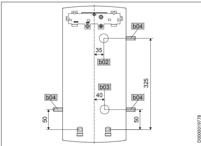
b02 спроведување на електричните водови I
