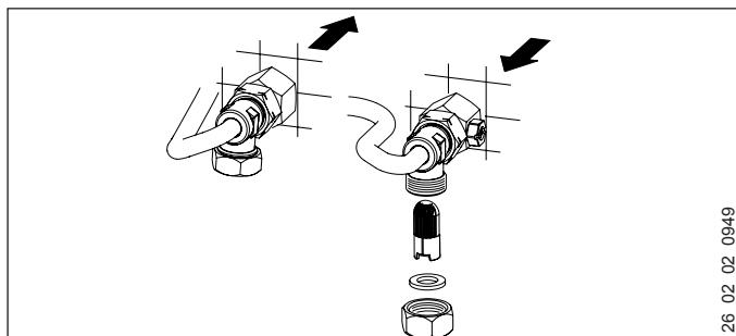
Очистить сетчатый фильтр в резьбовом соединении трубопровода холодной воды. Закрыть запорный вентиль в трубопроводе подачи холодной воды, демонтировать сетчатый фильтр, очистить его и установить снова.
