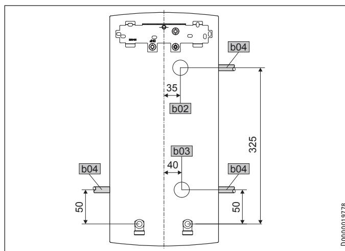
b02 Przepust na przewody elektryczne I
