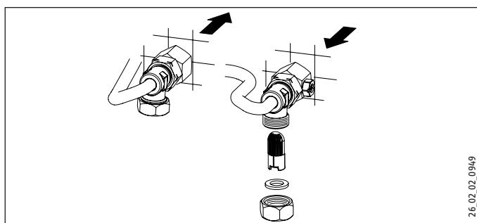
Limpie el filtro en la unión de tornillo del agua fría si está sucio. Cierre la válvula de cierre en el tubo de alimentación de agua fría antes de desmontar el filtro, de limpiarlo y de volverlo a montar.
