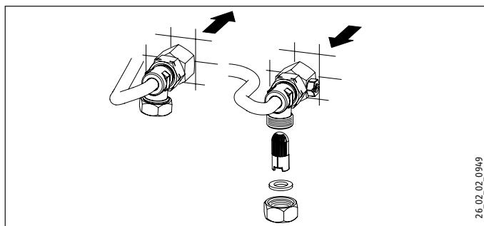
U slučaju zaprljanja čistite sito u priključku sa šrafovima za hladnu vodu. Zatvorite ventil za zatvaranje u dovodnom cevovodu hladne vode pre nego što izvadite, očistite i ponovo uglavite sito.
