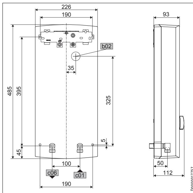
b02 Przepust na przewody elektryczne I
