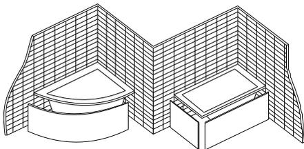
**PL** Dla wanień proponujemy obudowy znajdujące się w ofercie KOŁO. Wanny wyposażone są w standardowe nóżki, które służą wy poziomowaniu wanny i ułatwieniu montażu.
