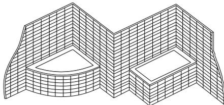
**PL** Wanny można również zabudować płytkami ceramicznymi, podmuruwując dno i brzegi wanny oraz wykorzystując nóżki dla łatwiejszego montażu i poziomowania. Zabudowę wanny należy wykonać w taki sposób, aby umożliwić wyjęcie wanny w razie konieczności.
